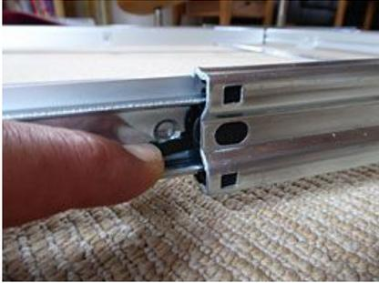
Die Schublade wird an den Seiten entriegelt (links und rechts entgegengesetzt) und kann dadurch komplett herausgezogen werden.
